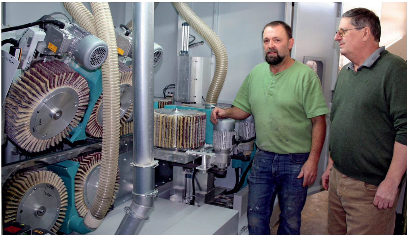
/ Ein Blick unter die Haube der Roba Fentech: Besonders große Schleifwerkzeuge sorgen für maximierte Berührungsfläche mit dem Werkstück. Mittels Teiles scanner angesteuert, fahren die Aggregate schnell die individuellen Basispositionen an – manuelles Einstellen entfällt.
